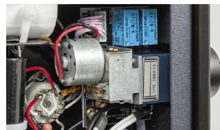
Regulacja głośności jest klasyczna – z potencjometrem Alpsa.
