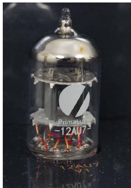
Podwójne triody 12AU7 mają oznaczenia firmy PrimaLuna.
